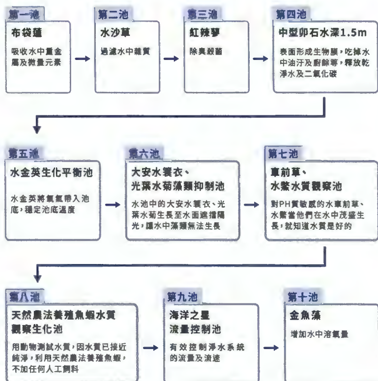
圖4.1.5:【淨水2.0】十個淨化功能池運作流程
